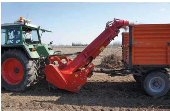
Fréza SEPPI M typ MIDIFROST DRAGO při drcení větví v sadu a sběru biomasy, vhodný pro kompostárny, bioplynové stanice, apod. Stroj drtí dřevo a nálety až do síly 12 cm.
