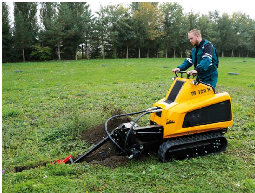
Drážkovač LASKI TR 120 H při práci
